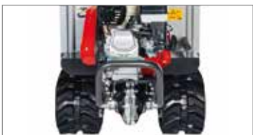
Protezione posteriore in metallo per tutelare la sicurezza dell'operatore.
